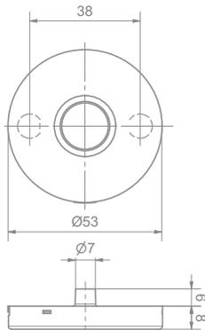
Paire de rosaces de poignée clipsées, diamètre 53 mm, avec plaque de base en plastique, cache à clipser en acier inoxydable mat, entaille du capot: 21 mm ou 23 mm
