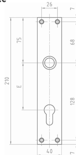
Paire d'entrées longues carrées, longueur 210 mm, largeur 40 mm, hauteur 2 mm, acier inoxydable mat, guide en acier.
